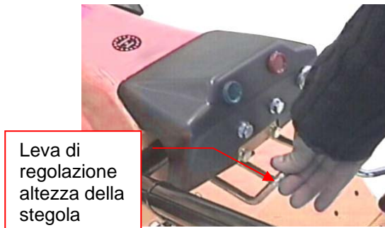
Figura 8 - Regolazione altezza stegola
