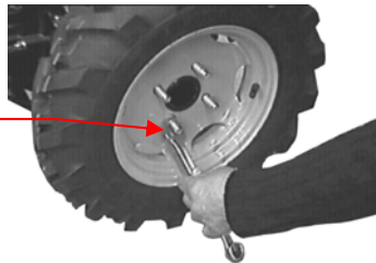
Figura 11 - Regolazione ruote con flangia
