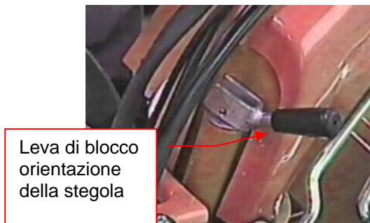
Figura 9 - Regolazione orientazione stegola
